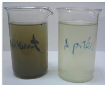
Décontamination de l'eau usée industrielle traitée par le biocoagulant d'*Opuntia ficus-indica*(L.) Mill.
