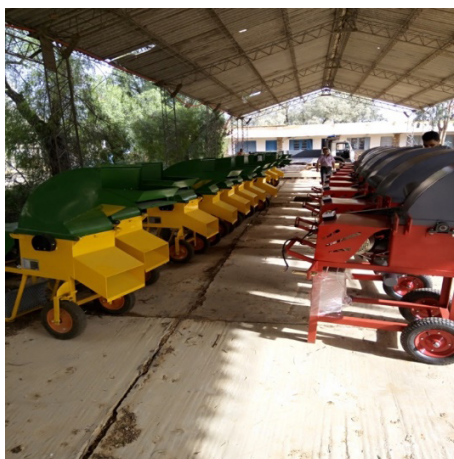
Technologie de la ration complète destinée aux ruminants : Hachoir mécanisé fabriqué localement
